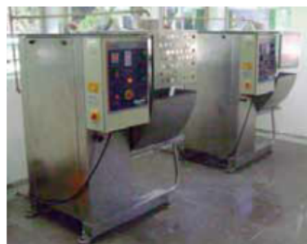
Figura 2: Fulões utilizados nos testes de aplicação em escala piloto
