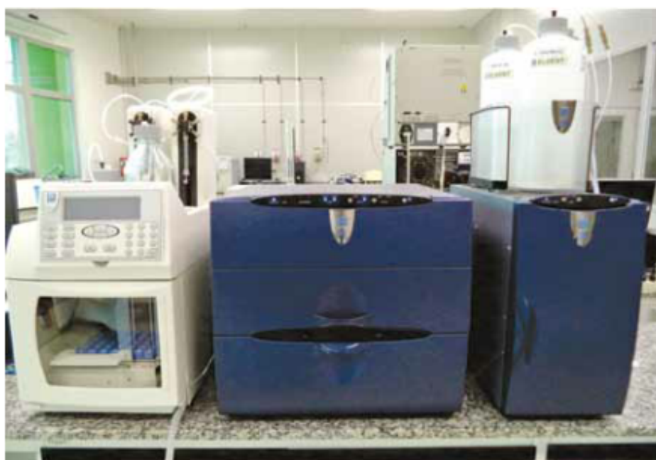
Figura 3: Cromatógrafo iônico utilizado na determinação de sulfatos
