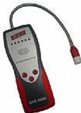
Figura 1 – Detector para GLP/GN portátil Fonte: (INFO ESCOLA, 2014)
