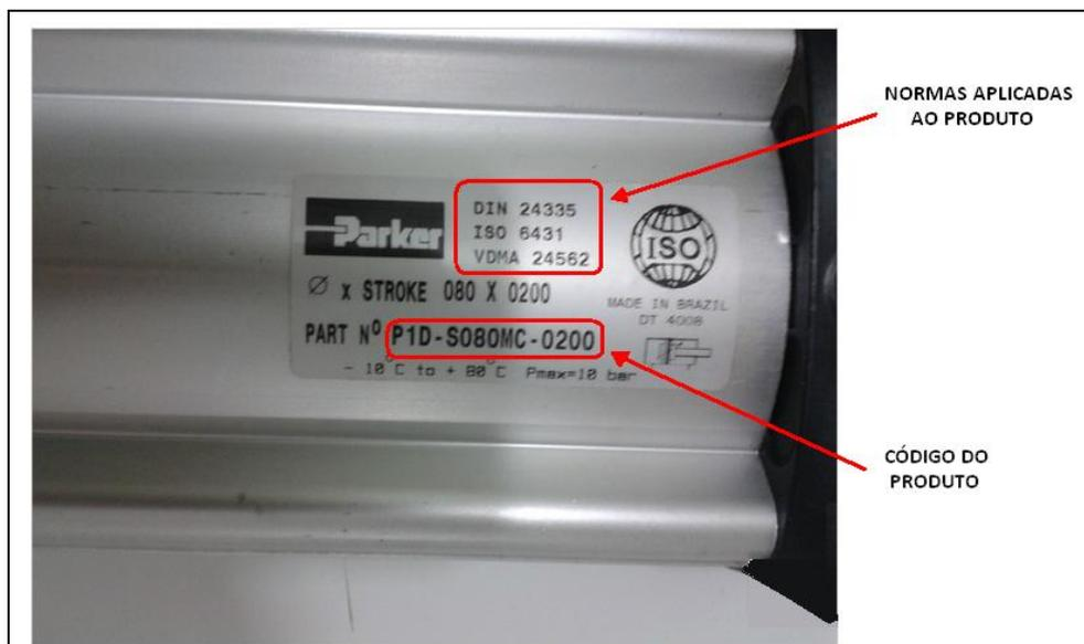
Figura1 – Códigos de especificação em cilindro pneumático
