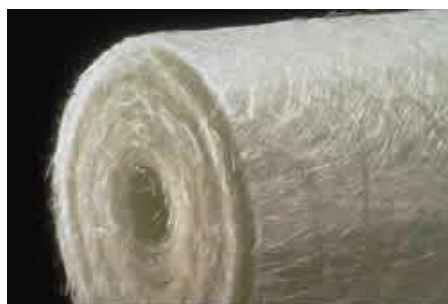
Figura 1 – Fibra de vidro em rolo Fonte: (INFO ESCOLA, 2014)
