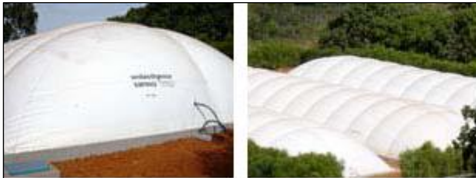
Figura 1 – Imagens de biodigestores com balões de armazenamento em vinimanta Fonte: (SANSUY, c2015)
