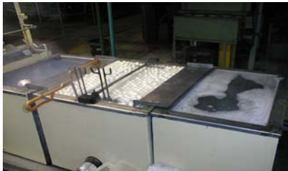
processo de galvanização
