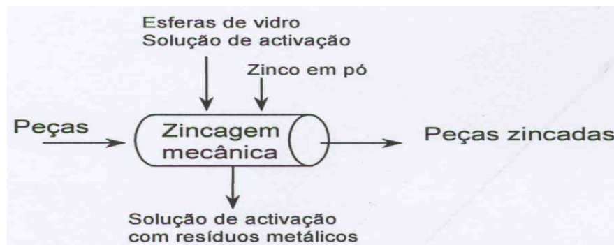
Figura 8 - Entradas e saídas de materiais do processo de zincagem mecânica. Fonte: Instituto Nacional de Engenharia e Tecnologia Industrial, 2007.
