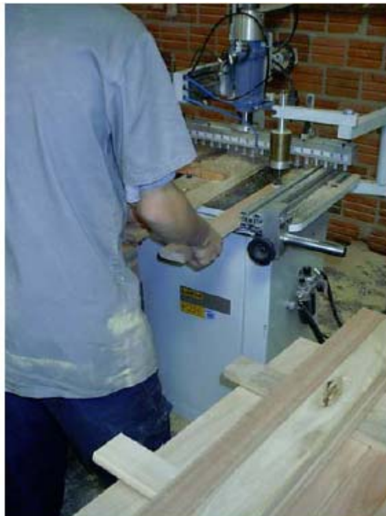
Figura 54 - Furação realizada na furadeira múltipla automática - Emilar Móveis Fonte: Centro Tecnológico do Mobiliário - SENAI, 2005.
