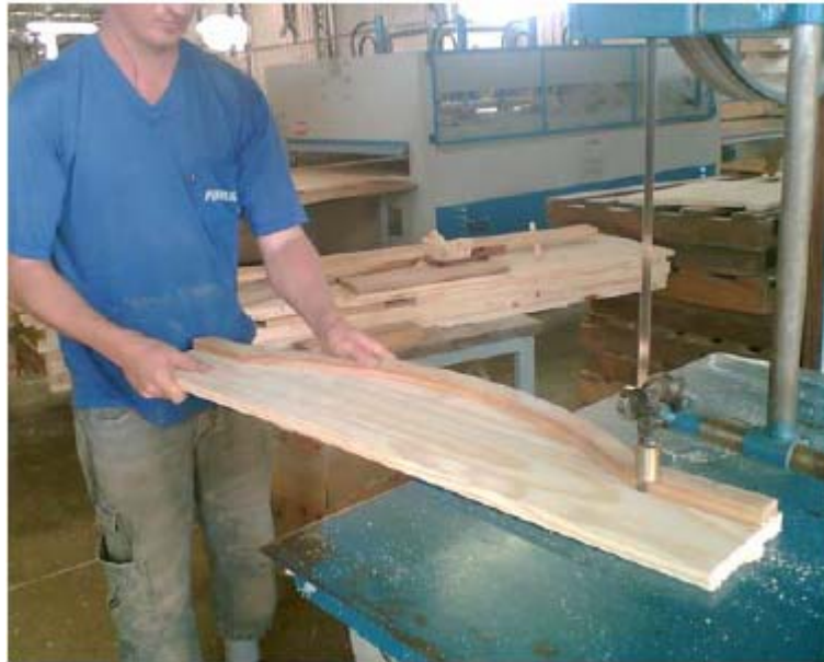
Figura 47 - Gabarito para peças curvas na serra de fita - Projeto SEBRAE-SC Fonte: Centro Tecnológico do Mobiliário - SENAI, 2006.
