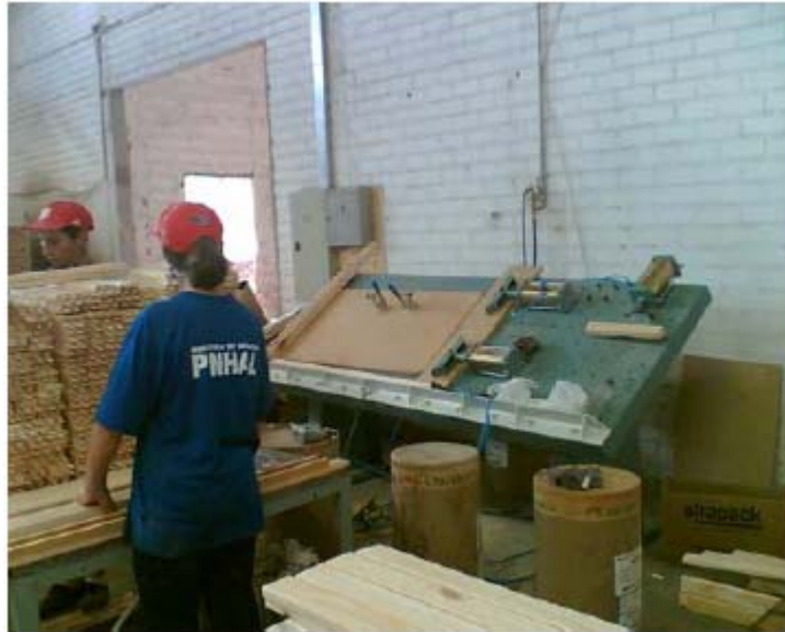
Figura 43 - Prensa de painéis com gabarito - Projeto SEBRAE-SC Fonte: Centro Tecnológico do Mobiliário, 2006.
