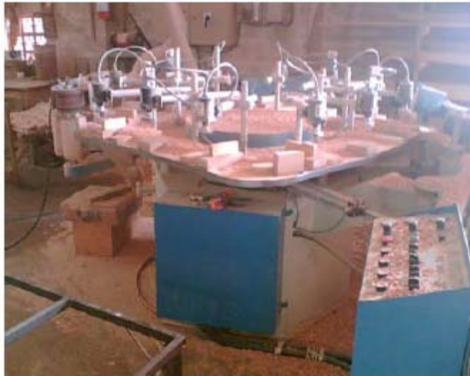
Figura 41 - Tupia copiadora com gabaritos fixos - Projeto SEBRAE-SC. Fonte: Centro Tecnológico do Mobiliário - SENAI, 2006.
