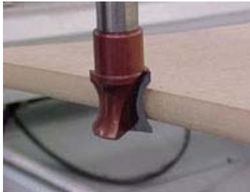
Figura 22 - broca de bolear em centro de usinagem. Fonte: Borcas, 2007.
