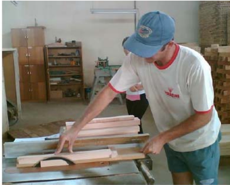
Figura 45 - Gabarito para corte em ângulo na serra circular - Projeto Móveis Piratini Fonte: Centro Tecnológico do Mobiliário - SENAI, 2006.
