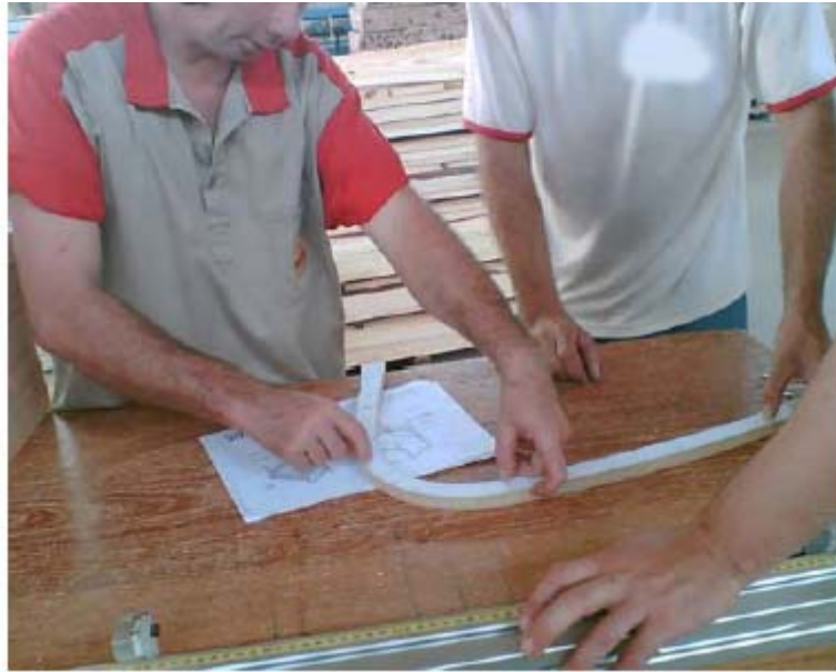
Figura 50 - Desenho técnico colado sobre base de madeira - Projeto Móveis Piratini Fonte: Centro Tecnológico do Mobiliário - SENAI, 2006.
