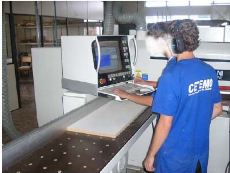
Figura 53 - Corte de peças nas medidas finais Fonte: Centro Tecnológico do Mobiliário - SENAI, 2006
