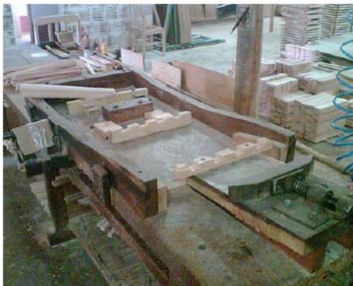
Figura 42 - prensa de montagem de cadeira com gabarito - Projeto SEBRAE-SC. Fonte: Centro Tecnológico do Mobiliário - SENAI, 2006.
