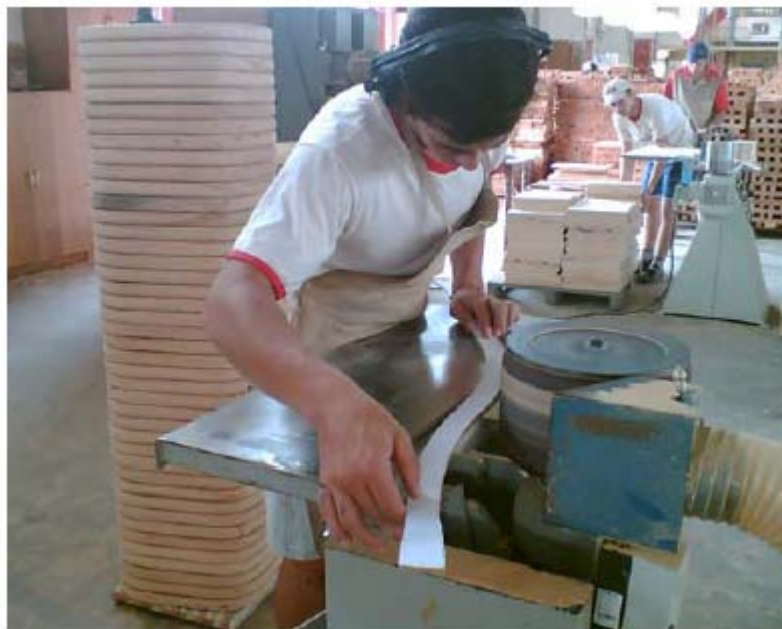
Figura 51 - Gabarito sendo lixado na lixadeira de bordas - Projeto Móveis Piratini Fonte: Centro Tecnológico do Mobiliário - SENAI, 2006
