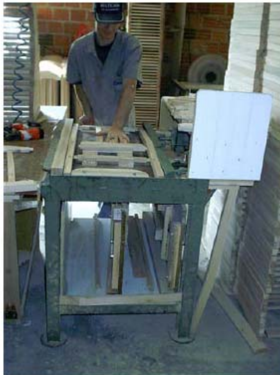
Figura 55 - Montagem de cadeira na prensa com gabarito - Emilar Móveis Fonte: Centro Tecnológico do Mobiliário - SENAI, 2005.
