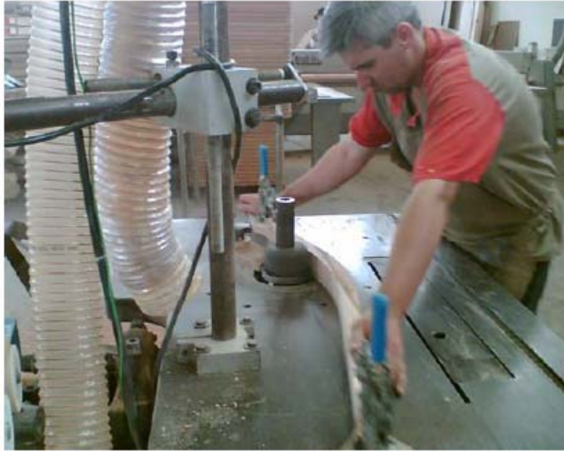
Figura 49 - Gabarito para usinagem em tupia - Projeto Móveis Piratini Fonte: Centro Tecnológico do Mobiliário - SENAI, 2006.
