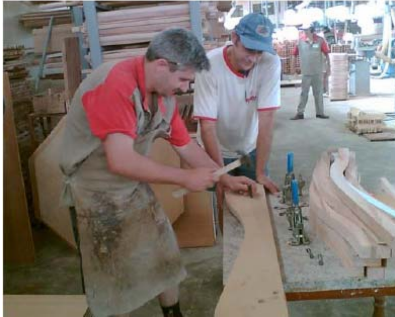
Figura 52 - Sistema de fixação sendo instalado no gabarito - Projeto Móveis Piratini Fonte: Centro Tecnológico do Mobiliário - SENAI, 2006.
