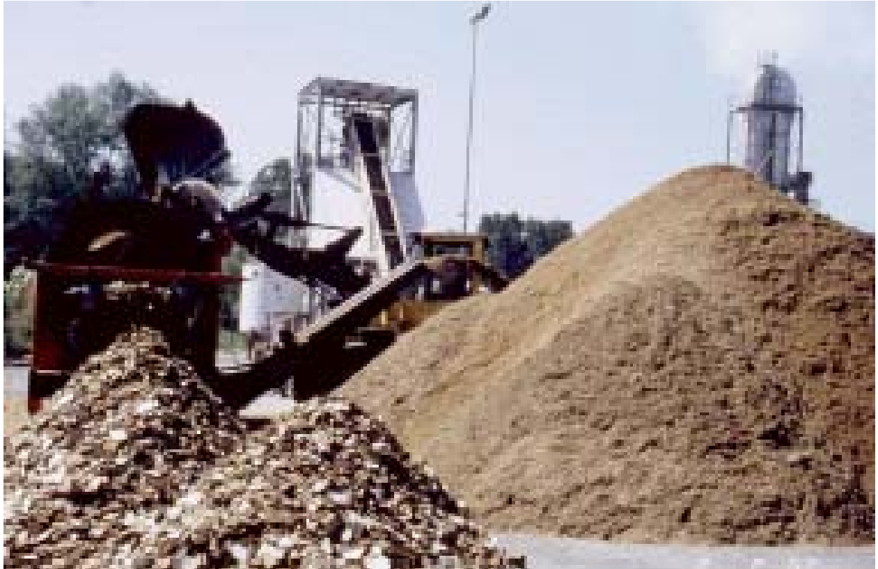
FIG. 6 - Equipamentos da WKI para desintegrar retalhos de chapas de aglomerado Fonte: Wilhelm-Klauditz-Institut Braunschweig, 2004.
