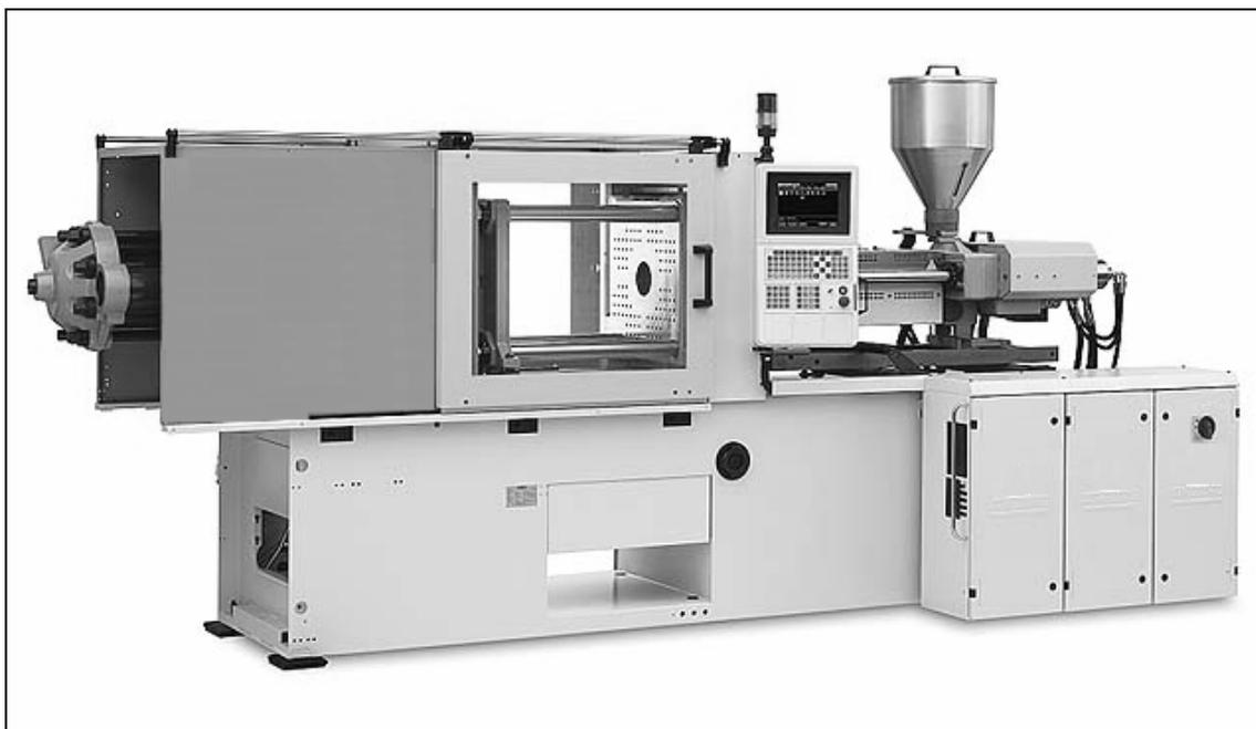
Figura 1 - Máquina injetora.
