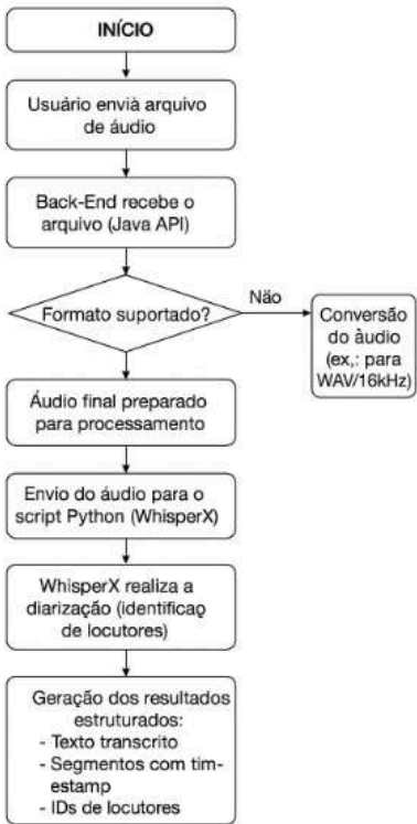
Fig. 1 - Fluxo do Back-End e Pipeline de Transcrição: Esta imagem apresenta as etapas da transcrição.
