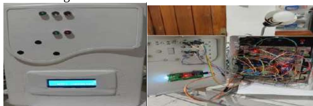
Fig.31–Resultado Montagem física painel de comando
