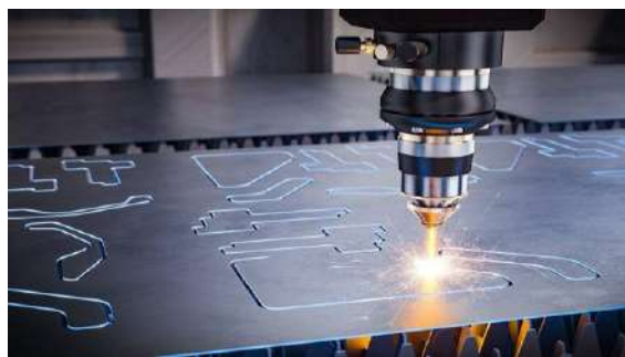
Fig. 1. Corte a laser em chapa inox Fonte: STELLINTER, 2025.
