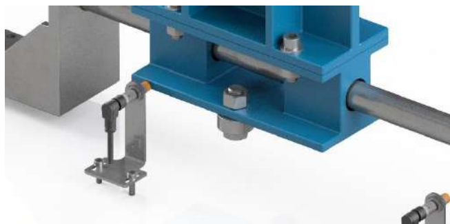
Fig. 3 Ilustração 3D da troca das chaves para sensor
