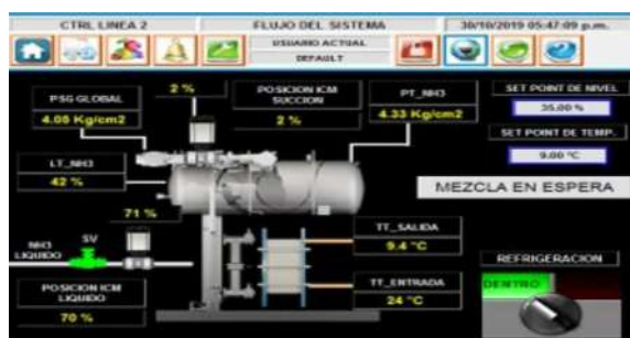
Figura 1 – Ciclo de Refrigeração com Amônia
