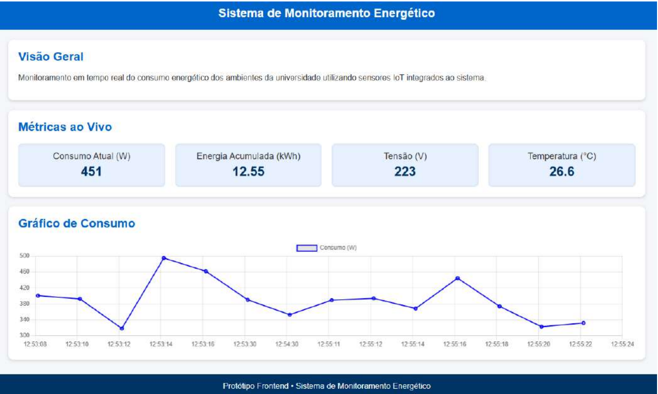
Fig. 1. Interface do protótipo frontend exibindo métricas e gráfico de consumo energético simulado.
